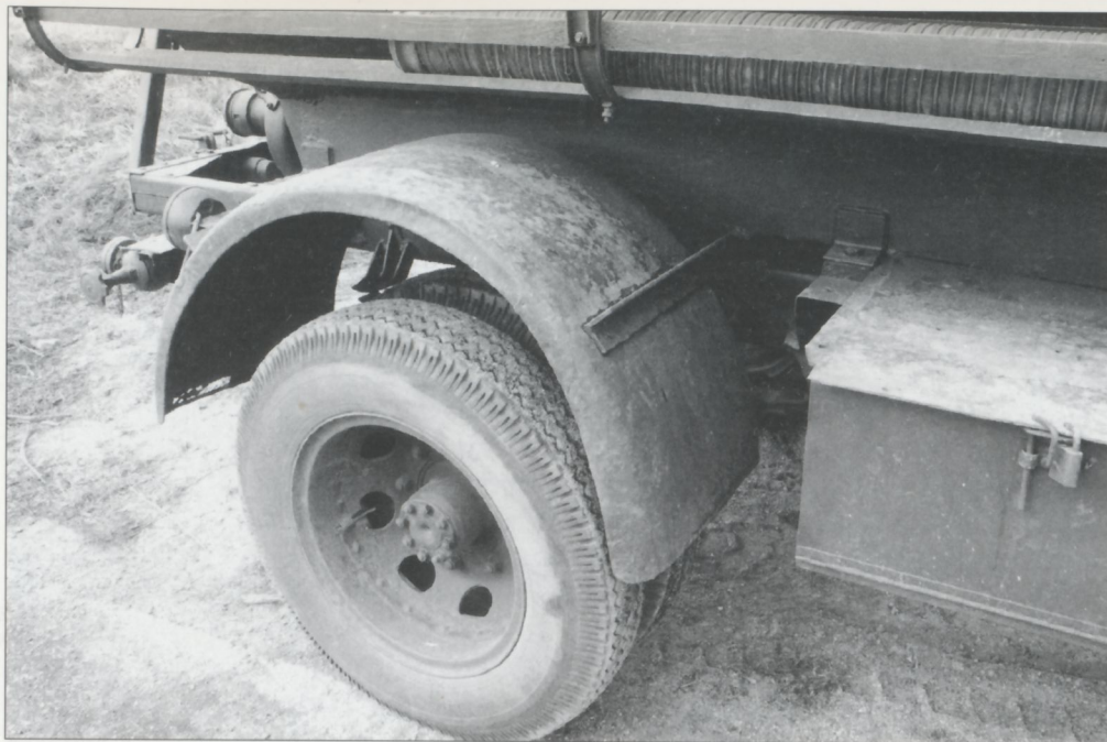
Pictures on left side show rear mudguards and accessory boxes. Obrázky nalevo ukazují zadní blatníky a schránky na hasební pomůcky.
