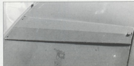
Na obrázku vpravo nahoře jsou vidět upínací háky kapoty na Blitzu 4x4, porovnejte je s obrázkem dole uprostřed na vedlejší stránce, kde jsou tytéž háky na Blitzu 4x2.
