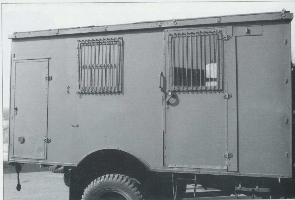
Boční pohled na standardní víceúčelovou skříňovou nástavbu (LC/Koffer). Všimněte si, že přední a zadní postranní okna jsou různá.
