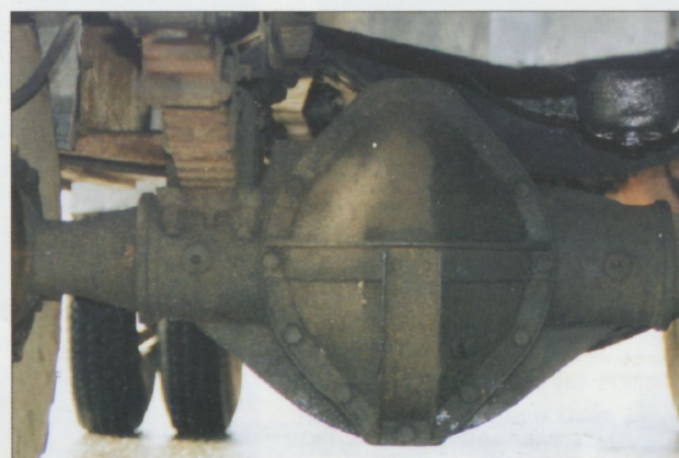
Detaily přední hnané nápravy na podvozku 4x4. Náhon kardanu pohánějícího vzadu umístěné čerpadlo je vidět na obrázku vlevo nahoře.
