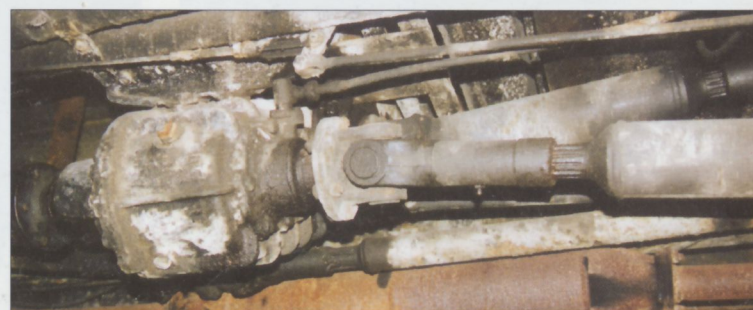
Spodní obrázky ukazují přídavnou převodovku na podvozku 4x4 a kardan pohánějící čerpadlo.
