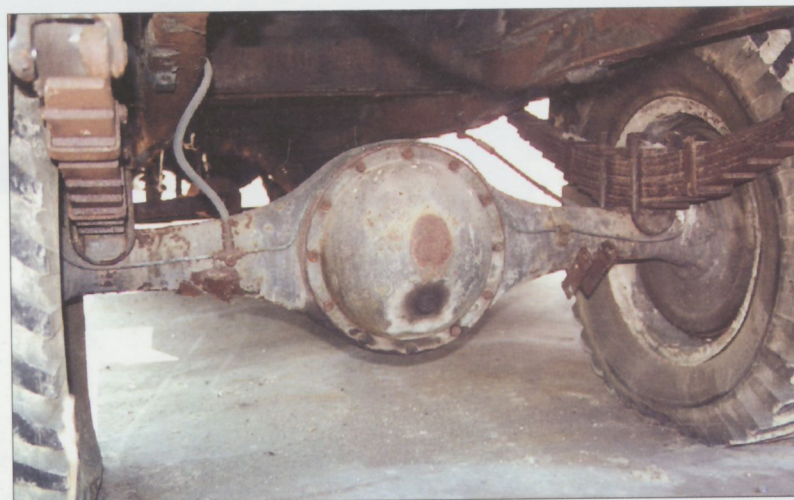
Skříně diferenciálu na Blitzu byly ve dvojím typickém provedení. Na obrázku vpravo dole je původní skříně typu banjo, na obrázku vlevo dole vidíte pozdější modifikaci, která byla užívána také v provedení 4x4.
